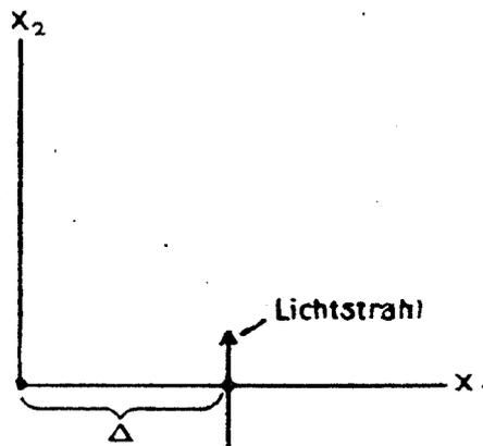
Wir untersuchen die Krümmung, welche ein Lichtstrahl erleidet, der im Abstand  $\Delta$  an einer Masse  $M$  vorbeigeht. Wählt man das Koordinatensystem gemäß der vorstehenden Skizze, so ist die gesamte Biegung  $B$  des Lichtstrahles (positiv gerechnet, wenn sie nach dem Ursprung hin konkav ist) in genügender Näherung gegeben durch
